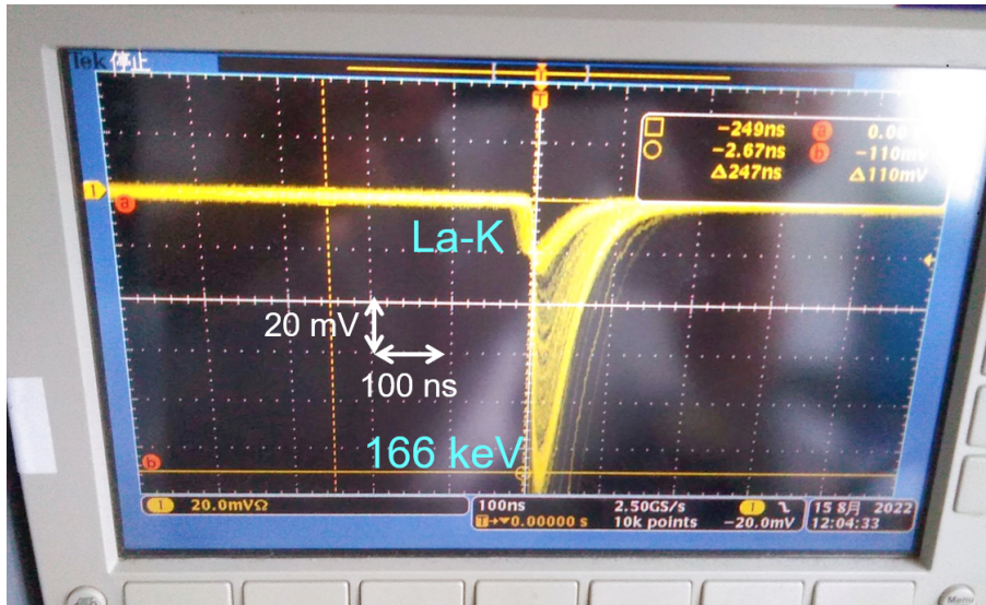
図 4.22 CeBr 3 シンチレータに 139 Ce を照射したときの波形
