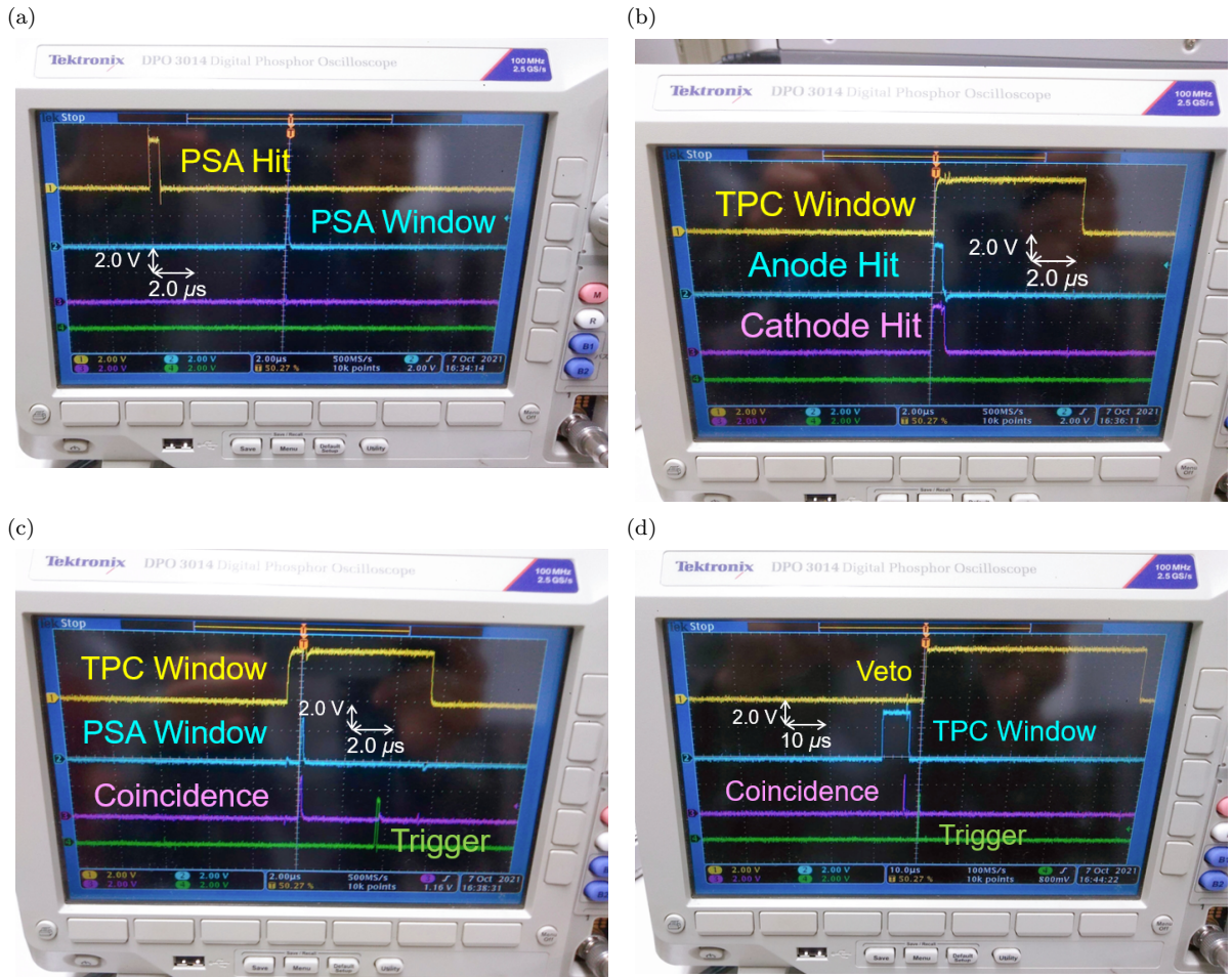
図 3.20 (a)PSA Hit 信号 (黄) から PSA Window 信号 (シアン) を生成。 (b)TPC のアノード (シアン)、カソード (マゼンタ) のヒットから TPC Window 信号 (黄) を生成。 (c)TPC Window 信号 (黄) と PSA Window 信号 (シアン) から Coincidence 信号 (マゼンタ) が生成され、そこから Trigger 信号 (緑) も生成。 (d)Trigger 信号 (緑) を受信した TPC と PSA がデータの整形、転送を開始することで生じる Veto 信号 (黄)
