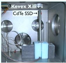
図 5.13 CdTe SSD によるスペクトル測定のセットアップ。左: $^{109}$ Cd の測定。右: $^{109}$ Ce の測定。
