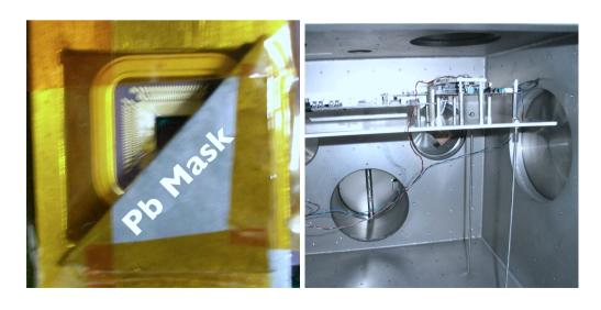
図 5.15 INTPIX2 に付けた Pb マスク (左) と照射セットアップの写真 (右)。
