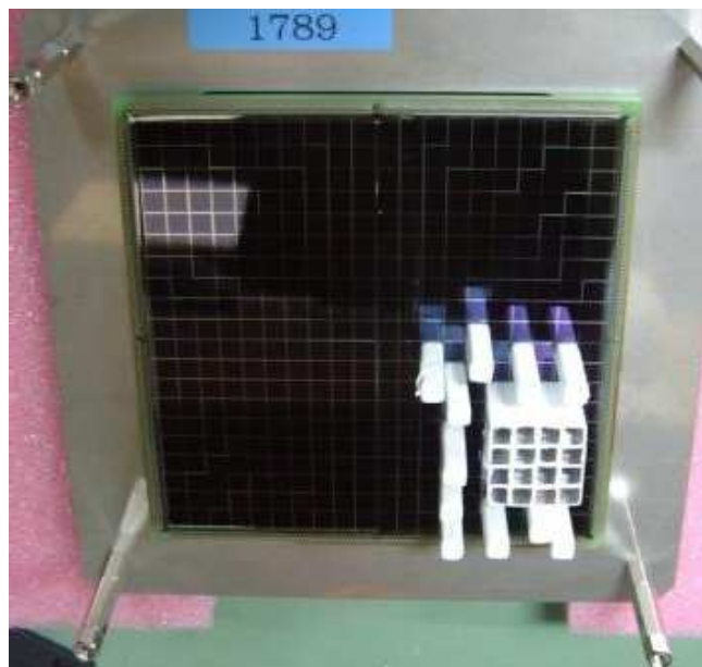
図 6.1: 写真：PDA1789に試験用CsI(Tl)ピクセルシンチレータを接着
