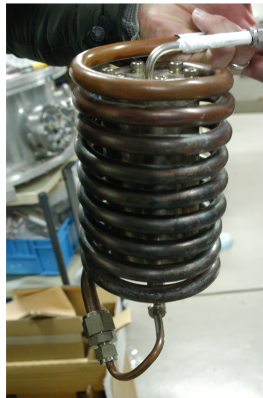
図 6.5: 活性炭を封入し、ガスを通わせる容器。外側の直径 12.7 mm の螺旋状の銅パイプと、内側の円筒状のステンレス容器から成る。銅パイプの曲げ加工は、パイプベンダーを用いて行った。
