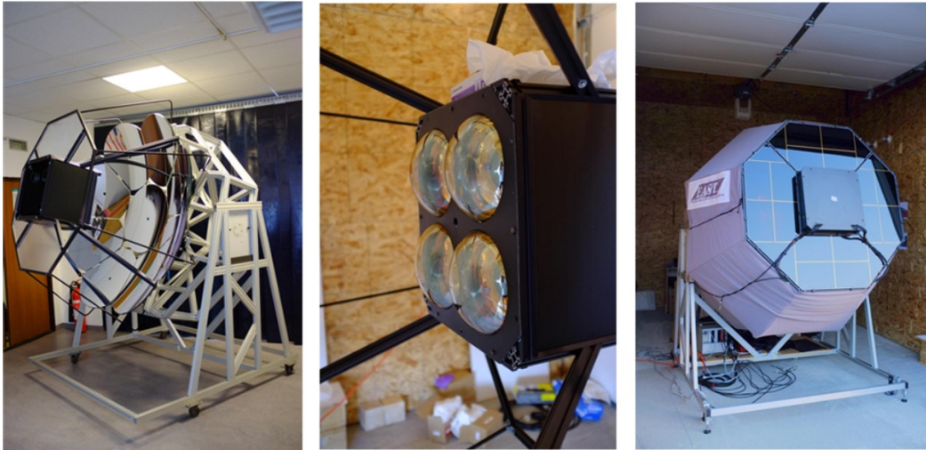
図 2.2: (左) FAST-FD にて使用される分割鏡。(中央) カメラ部分での PMT の配置。それぞれの PMT が直径 8 インチである。(右) TA の BRM サイトにて設置された FAST-FD の 1 号機。このために建設されたシェルター内に FD は設置されている。
