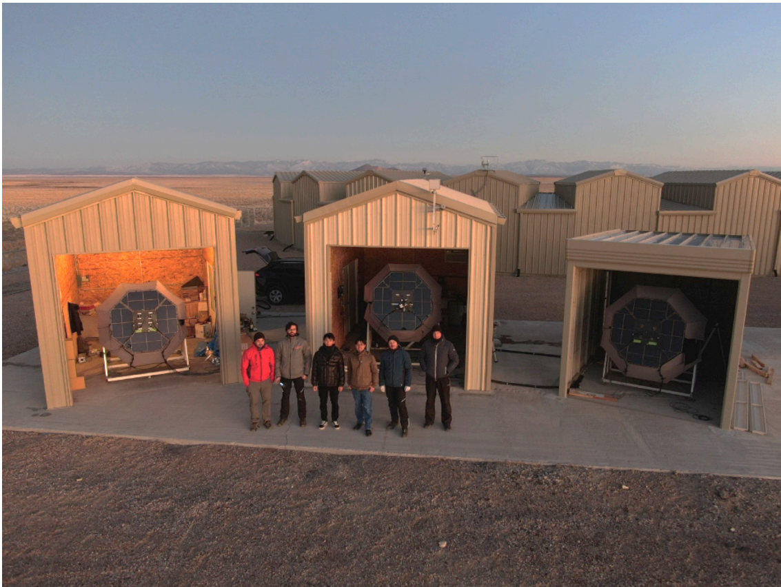
図 2.4: 米国ユタ州中央部に位置する TA の BRM サイトに設置された FAST の 3 つの試作望遠鏡。左から順に FAST-FD の 1,2,3 号機であり、中央の 2 号機には全天カメラの FASCam と大気モニタ用の SQM が取り付けられている (FASCam と SQM については後述する)。
