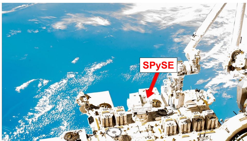
図 2.2.1: ISS の船外プラットフォームに設置された小型ペイロード搭載支援装置 (SPySE) の写真 [49]。
