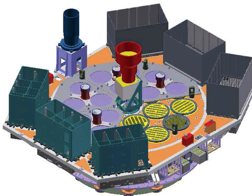
図 3.2.1: HXMT の構造 [91]。左側の 3 つの箱が Low Energy X-ray Telescope (LE、1–15 keV)、右側の 3 つの箱が Medium Energy X-ray Telescope (ME、5–30 keV)、中心にある 18 個の検出器が High Energy X-ray Telescope (HE、20–250 keV) である。
