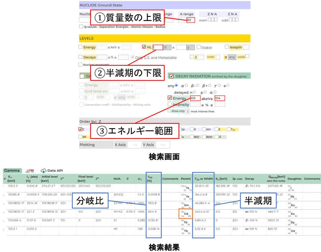
図 4.4.10: IAEA の核図表を用いた放射性同位体特定の手法。上部は検索画面である。質量数の上限は、GAGG の組成 (Gd 3 Al 2 Ga 3 O 12 ) から最大の質量数 160 に照射陽子分の 1 を足した 161 とした。半減期の下限は、長寿命成分を見ていることを考慮して 1 日とした。エネルギー範囲は表 A.11 と表 A.12 のそれぞれのエネルギー値を用いている。下部は検索画面である。分岐比と半減期を確認し、適切な同位体を取り出している。この図では 153 Gd を特定している。
