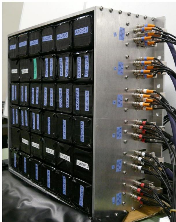
図 4.9: 30cm 角シンチレーションカメラ
