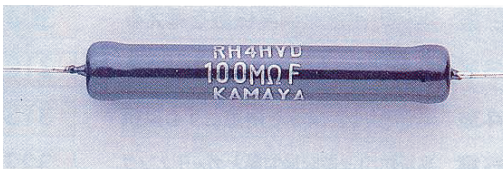
〈写真 8〉メタル・グレース抵抗 (高抵抗)： 10\text{ M}\Omega 以上の高抵抗領域用。超高抵抗では浮遊容量にも配慮が必要。
