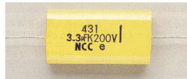
〈写真19〉 メタライズド・フィルム・コンデンサ：誘電体はポリエステルなど、実用容量範囲は 1000\text{pF} ～ 1\mu\text{F} 。比較的小型。
