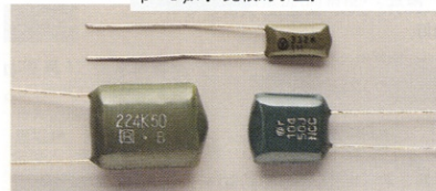
〈写真21〉 マイラ・コンデンサ：誘電体はポリエステル、実用容量範囲は 470\text{pF} ～ 0.47\mu\text{F} 。巻きインダクタンスに注意。
