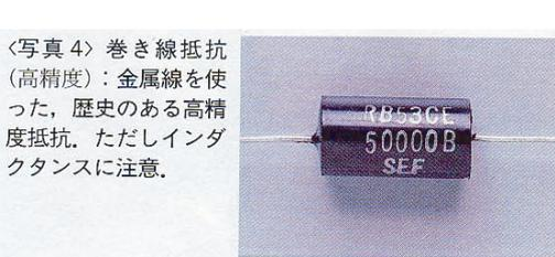
〈写真4〉巻き線抵抗(高精度)：金属線を使った、歴史のある高精度抵抗。ただしインダクタンスに注意。
