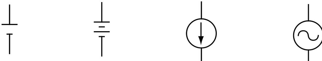
図 1.3: 左から, (1) 定電圧源, (2) 定電圧源, (3) 定電流源, (4) 交流電圧源。(4) は信号源として使う場合もある。
