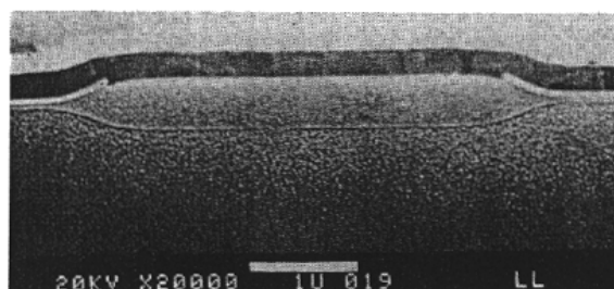
図 3.15: XIS のチャネルストップ構造
