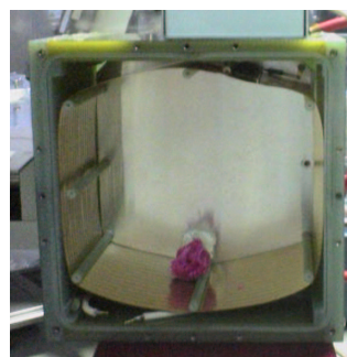
図 5.4 : gas package 内部の写真 (mantle 取り付け部)
