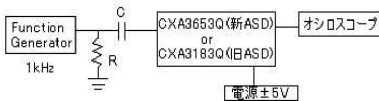
図 7: ASD の増幅率測定のための実験装置
