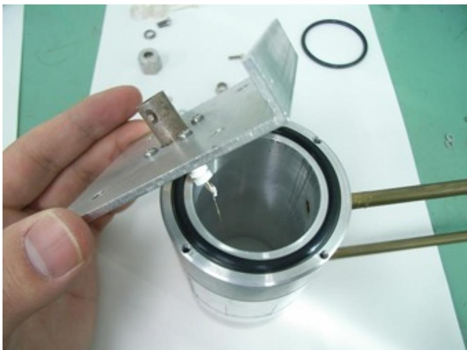
図6：ゴムOリングを装着したうえで、側面版をねじ止める。
