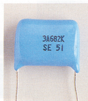
〈写真 22〉 ポリプロピレン (PP) コンデンサ：誘電体はポリプロピレン。実用容量範囲は 100\text{p}\sim 0.47\mu\text{F} 。誘電体吸収が小さいが、かさばる。
