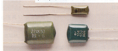
〈写真 21〉マイラ・コンデンサ：誘電体はポリエステル。実用容量範囲は 470\text{p}\sim 0.47\mu\text{F} 。巻きインダクタンスに注意。
