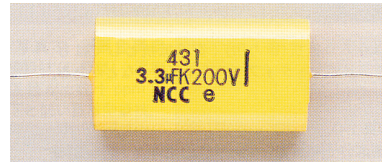
〈写真 19〉メタライズド・フィルム・コンデンサ：誘電体はポリエステルなど。実用容量範囲は 1000\text{p}\sim 1\mu\text{F} 。比較的小型。
