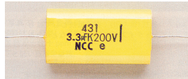
〈写真19〉メタライズド・フィルム・コンデンサ：誘電体はポリエステルなど。実用容量範囲は1000p~1 \mu F。比較的小型。
