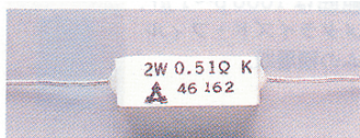
〈写真10〉セメント抵抗(電力用): おもに巻き線抵抗体を難燃性ケースに収めたもの。安全性/実装性とも良好。
