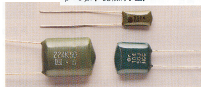
〈写真21〉マイラ・コンデンサ：誘電体はポリエステル。実用容量範囲は470p~0.47 \mu F。巻きインダクタンスに注意。
