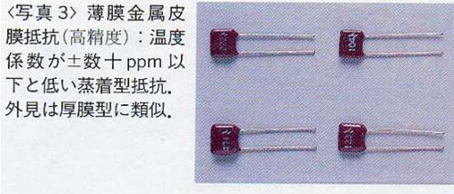
〈写真3〉薄膜金属皮膜抵抗(高精度)：温度係数が±数十ppm以下と低い蒸着型抵抗。外見は厚膜型に類似。
