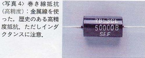
〈写真4〉巻き線抵抗(高精度)：金属線を使った、歴史のある高精度抵抗。ただしインダクタンスに注意。
