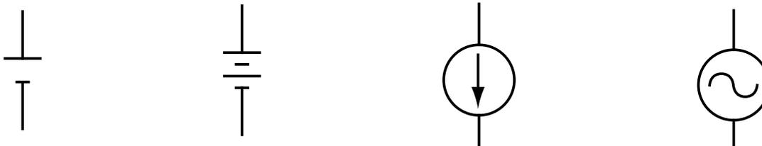
図 1.2: 左から、(1) 定電圧源、(2) 定電圧源、(3) 定電流源、(4) 交流電圧源。(4) は信号源として使う場合もある。
