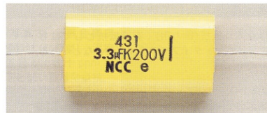
〈写真 19〉 メタライズド・フィルム・コンデンサ：誘電体はポリエステルなど。実用容量範囲は 1000 \text{p} ~ 1 \mu\text{F} 。比較的の小型。
