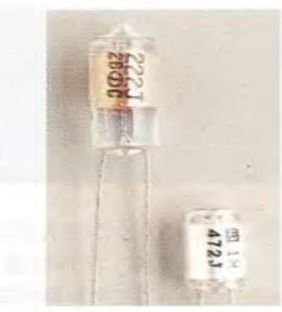
〈写真 24〉 スチロール・コンデンサ：誘電体はポリスチロール。実用容量範囲は1p~4700pF。特性良好だが熱や溶剤に弱い。
