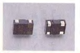
〈写真 14〉 有機高分子電解コンデンサ：誘電体は酸化アルミニウム。実用容量範囲は1 \mu ~470 \mu F。電解液がなく特性も良い。
