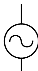
図 1.3: 左から, (1) 定電圧源, (2) 定電圧源, (3) 定電流源, (4) 交流電圧源. (4) は信号源として使う場合もある.
