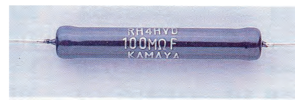
〈写真8〉メタル・グレース抵抗(高抵抗)：10 MΩ以上の高抵抗領域用。超高抵抗では浮遊容量にも配慮が必要。
