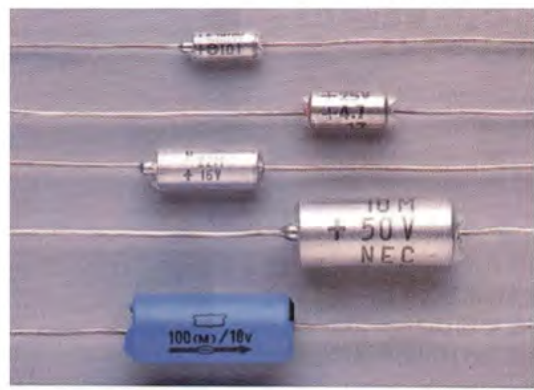
〈写真 15〉 タンタル電解コンデンサ：誘電体は酸化タンタル。実用容量範囲は0.1 \mu ~100 \mu F。もっとも小型だが、制限事項が多い。
