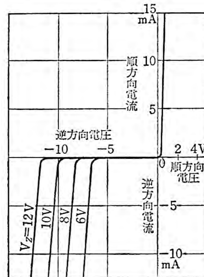
図 1.19: pn 型半導体ダイオード (左) とツェナーダイオードの電流電圧特性。
