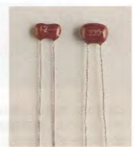
〈写真 25〉 マイカ・コンデンサ：誘電体はマイカ。実用容量範囲は0.5p~470pF。特性良好だが高価。
