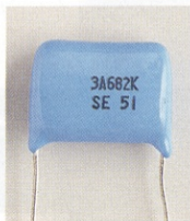
〈写真 22〉 ポリプロピレン (PP) コンデンサ：誘電体はポリプロピレン。実用容量範囲は 100 \text{p} ~ 0.47 \mu\text{F} 。誘電体吸収が小さいが、かさばる。
