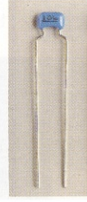
〈写真 18〉 積層セラミック・コンデンサ：誘電体は高誘電率系セラミック。実用容量範囲は 0.01 \mu\text{F} ~ 1 \mu\text{F} 。高誘電率セラミックの積層版。おもにパソコン用。
