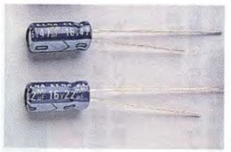
〈写真 12〉 アルミ電解コンデンサ：誘電体は酸化アルミニウム。実用容量範囲は 0.1 \mu\text{F} ~ 47000 \mu\text{F} 。汎用、小型、大容量で種類は多数ある。
