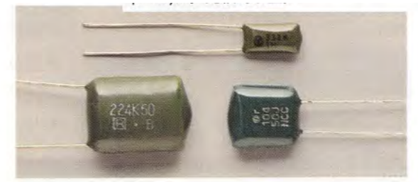
〈写真 21〉 マイラ・コンデンサ：誘電体はポリエステル。実用容量範囲は 470 \text{p} ~ 0.47 \mu\text{F} 。巻きインダクタンスに注意。
