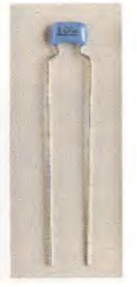
〈写真 18〉 積層セラミック・コンデンサ：誘電体は高誘電率系セラミック。実用容量範囲は 0.01 \mu\text{F} ~ 1 \mu\text{F} 。高誘電率セラミックの積層版。おもにパソコン用。
