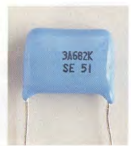
〈写真 22〉 ポリプロピレン(PP)コンデンサ：誘電体はポリプロピレン。実用容量範囲は 100 \text{p} ~ 0.47 \mu\text{F} 。誘電体吸収が小さいが、かさばる。
