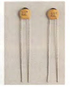
〈写真 21〉 マイラ・コンデンサ：誘電体はポリエステル。実用容量範囲は 470 \text{p} ~ 0.47 \mu\text{F} 。巻きインダクタンスに注意。
