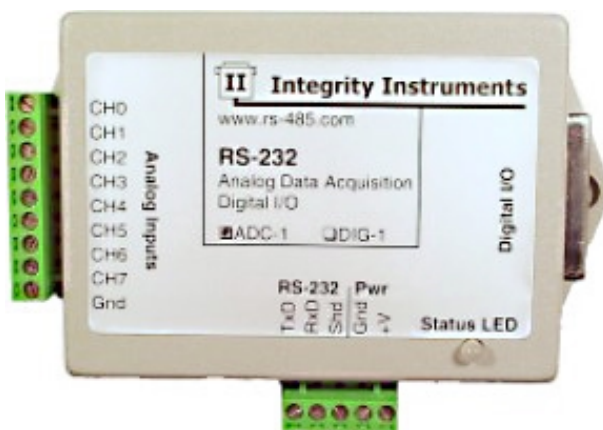
図 3.9: Cloud monitor。雲は赤外線を放出することから、赤外線に感度をもつセンサーの電流値を図の ADC で読み取る。ADC は RS232C 通信で操作する。
