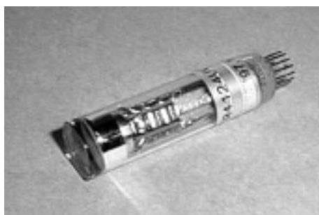
図 3.5: 光電子増倍管 R4124UV。直径 13 mm、長さ 50 mm。
