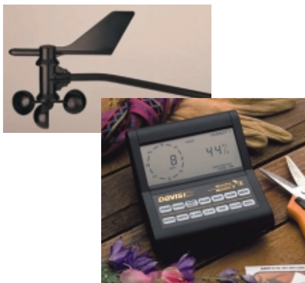
図 3.8: Weather monitor。風向、風力、湿度、気温、気圧が測定できるセンサー (上図) をコントロールボックス (下図) で読みとる。RS232C 通信で操作する。
