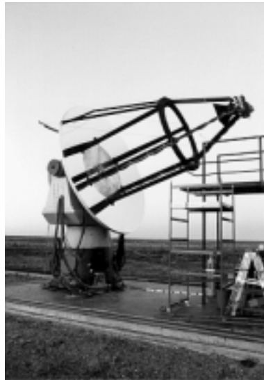
図 1.13: チェレンコフ望遠鏡の例:CANGAROO
