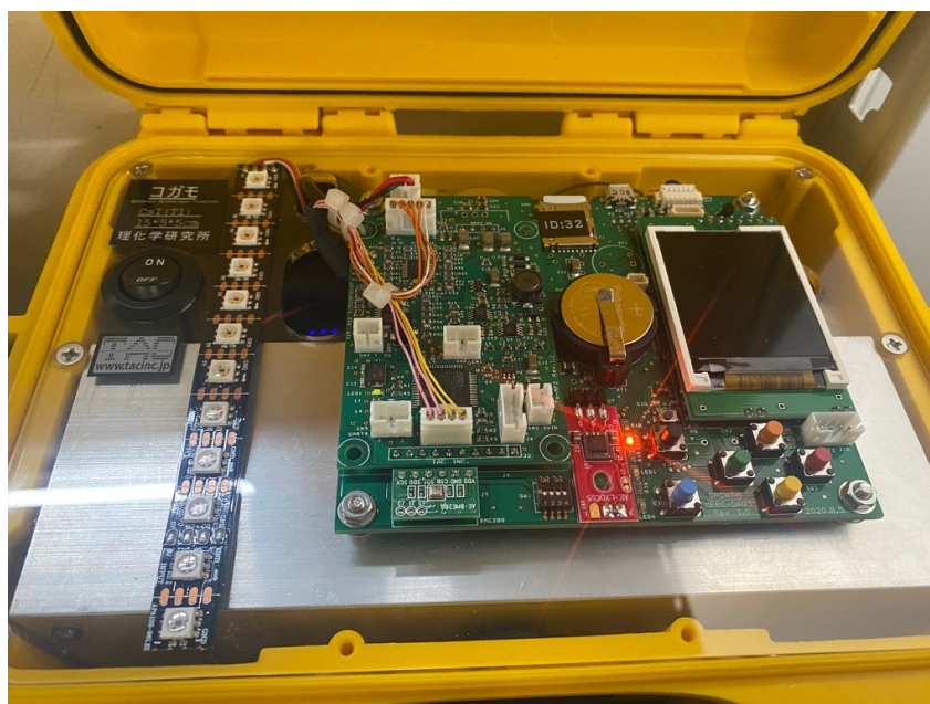
図 3.19 コガモ検出器の観測停止状態の時の基板の様子。基板の下のオレンジ色の LED が点灯する。
