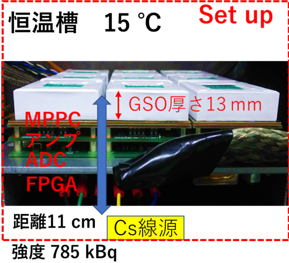
図 4.5.1: エネルギー分解能の測定時の実験セットアップの写真
