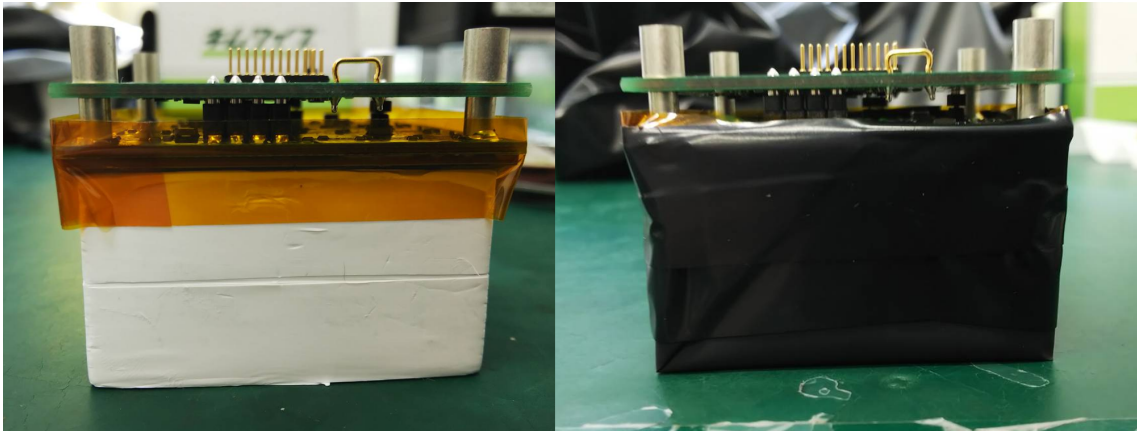
図 A.1.2: MPPC の遮光の写真。左側のようにカプトンテープで巻き、その上から遮光シートとブラックテープを巻いている (右)
