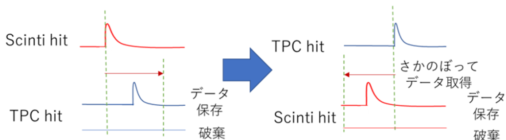
図 3.3.2: SMILE-2+でのトリガー方式 (common-start 型) と SMILE-3 で考えているトリガー方式 (common-stop 型) のイメージ図
