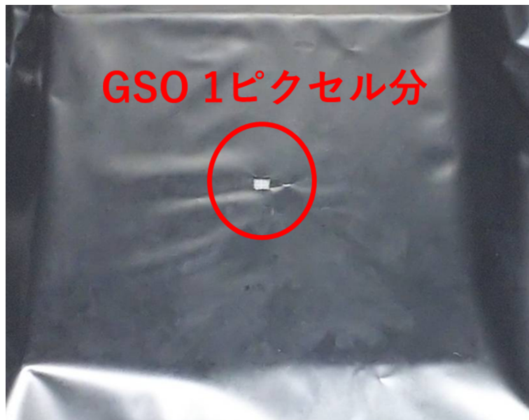
図 4.6.2: ダイナミックレンジ測定のために MPPC にマスクした図。GSO シンチレータの 1 ピクセル分の面積のみ光が入るようにしている。
