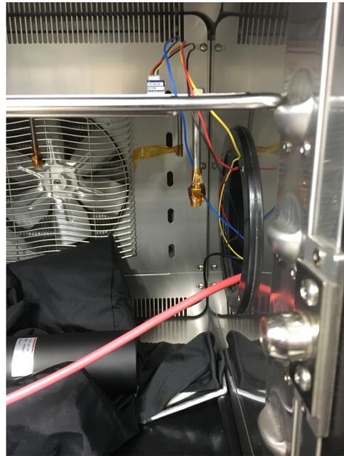
図 7.5: レーザー光の立ち上がり遅れ測定実験時の恒温槽内のセットアップ。
