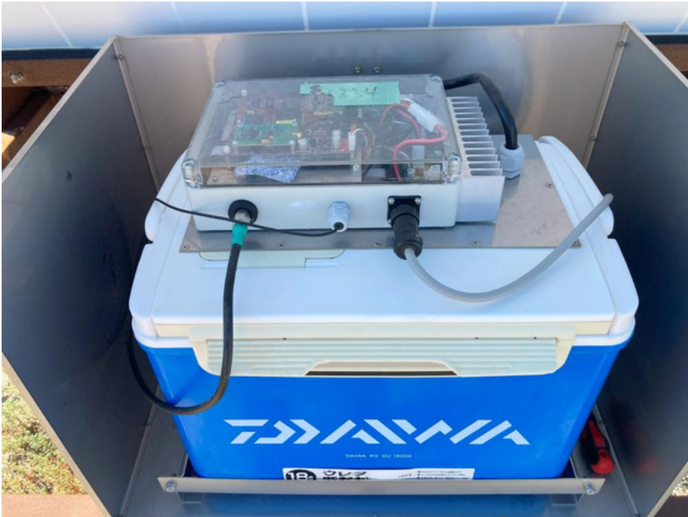
図 2.6: SD のエレクトロニクスが収納されている箱で、各 SD のソーラーパネルの裏側に置かれている。
