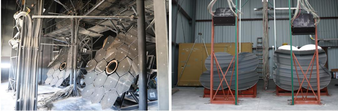
図 2.10: (左) TA 実験の BRM での FD の鏡. (右) TALE 実験での FD の鏡 [177].
