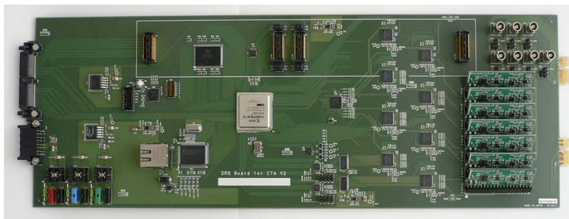
図 4.11 波形サンプリング回路 Ver.2 の写真。サイズは 14cm × 41.5cm
