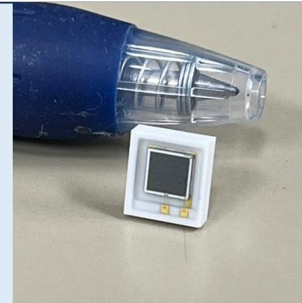
使用したMPPC : ---HAMAMATSU MPPC--- Type No. :S13360-3075CS
