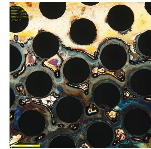
損傷した電極
