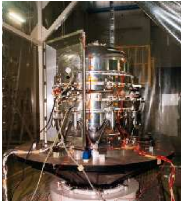
図 2.6: XRS 冷却システム外観
