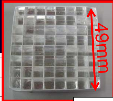
8 × 8 GSO array level
